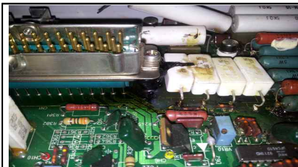
제동전자제어장치 열화(개선 전)
