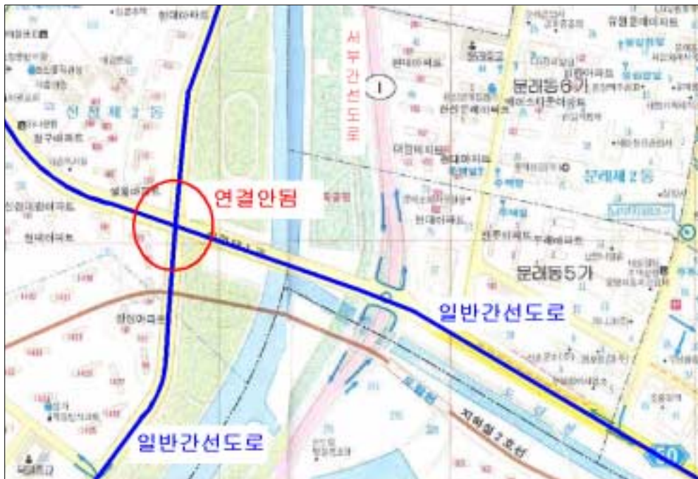
<그림 2-19> 일반간선도로간 교차불능으로 인한 연계교차로 기능상실
