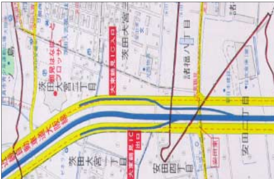
<그림 2-5> 진출·입 램프(Up-Down Ramp)를 이용한 연계 (일본 동경, 오사카)
