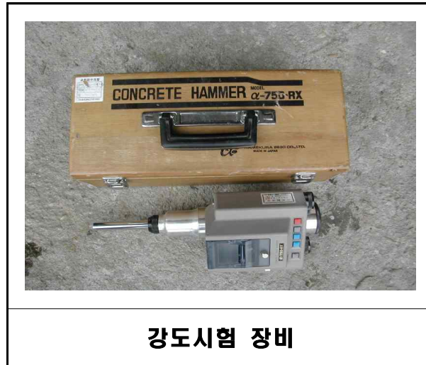
◀사진 3.1▶ 반발경도법(Concrete Test Hammer)
