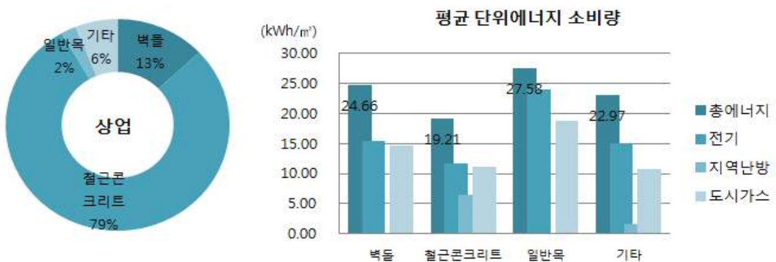
[그림 4-12] 상업부문 건물구조별 비중과 단위에너지소비
