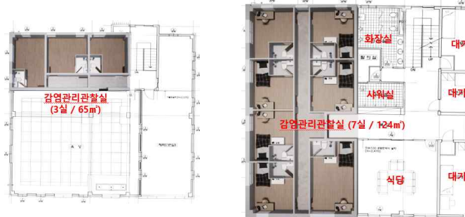
감염관리관찰실 설치 (2층 124㎡ 7실, 3층 65㎡ 3실)
