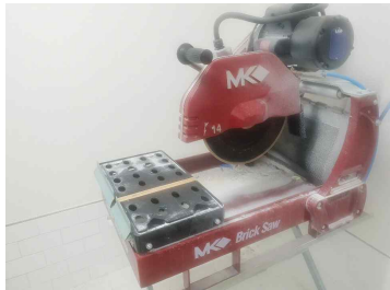
대형 원형 커팅기 대형 유리 및 석재류 절단 시 손을 날 옆에 넣어서 사용 ※ 현존하는 보호 장비 없음
