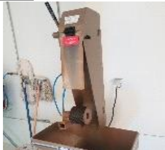
유리 및 금속 연마기 유리 및 석재류 연마 및 절삭 시 손을 넣어서 사용
