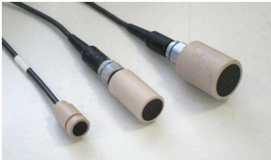
<그림 2-45> UT 측정 변위계
