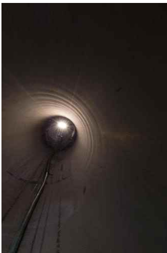
<그림 2-54> 카메라로 배관의 내부를 관찰하기 위해 삽입된 로봇 장비
