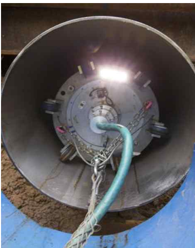
<그림 2-53> 배관의 건전성을 점검하기 위해 삽입된 로봇 검사장비
