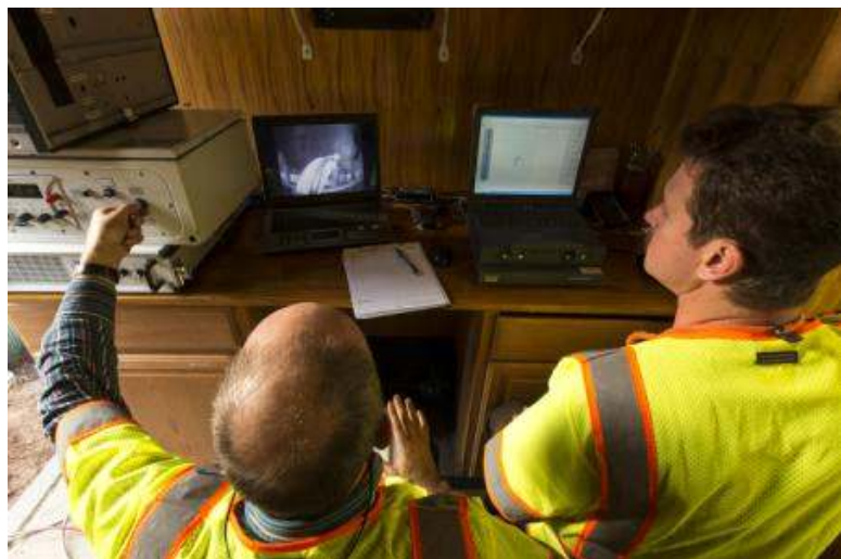
<그림 2-54> 카메라로 배관의 내부를 관찰하기 위해 삽입된 로봇 장비
