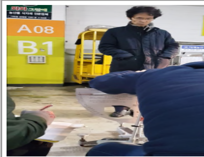
【사진.1】 주차장 바닥용 마감재(우레탄) 마찰계수 현장시험 (가락물 판매동 지하1층 주차장)
