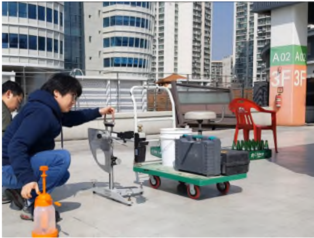
【사진.3】 주차장 바닥용 마감재(우레탄+규사) 마찰계수 현장시험 (가락물 판매동 지상3층 주차장)
