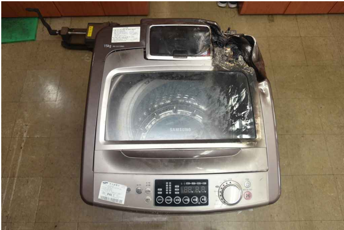
사진 12 세탁기 상부 소실 상태 촬영날짜 ○ 우측 상부 모서리 부근에서 연소된 형상임 '17. 8. 25.
