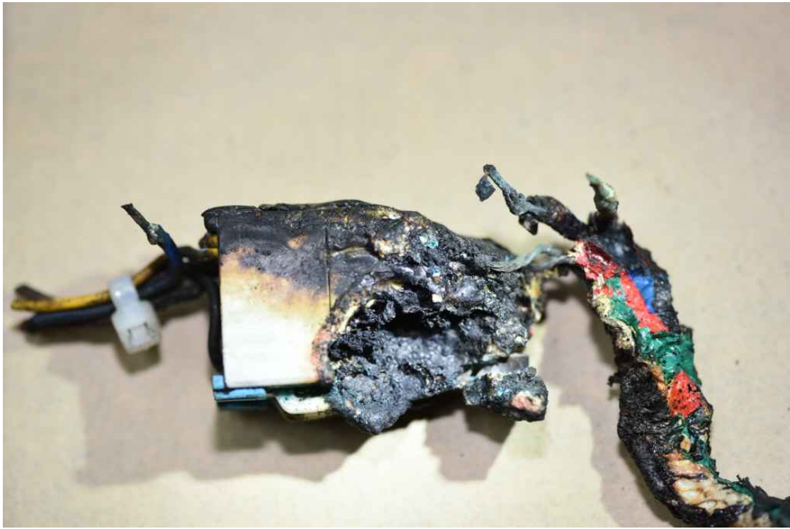
사진 23 커넥터 소실 상태 촬영날짜 ○ 수단자 2점이 분리된 상태임 '17. 8. 25.
