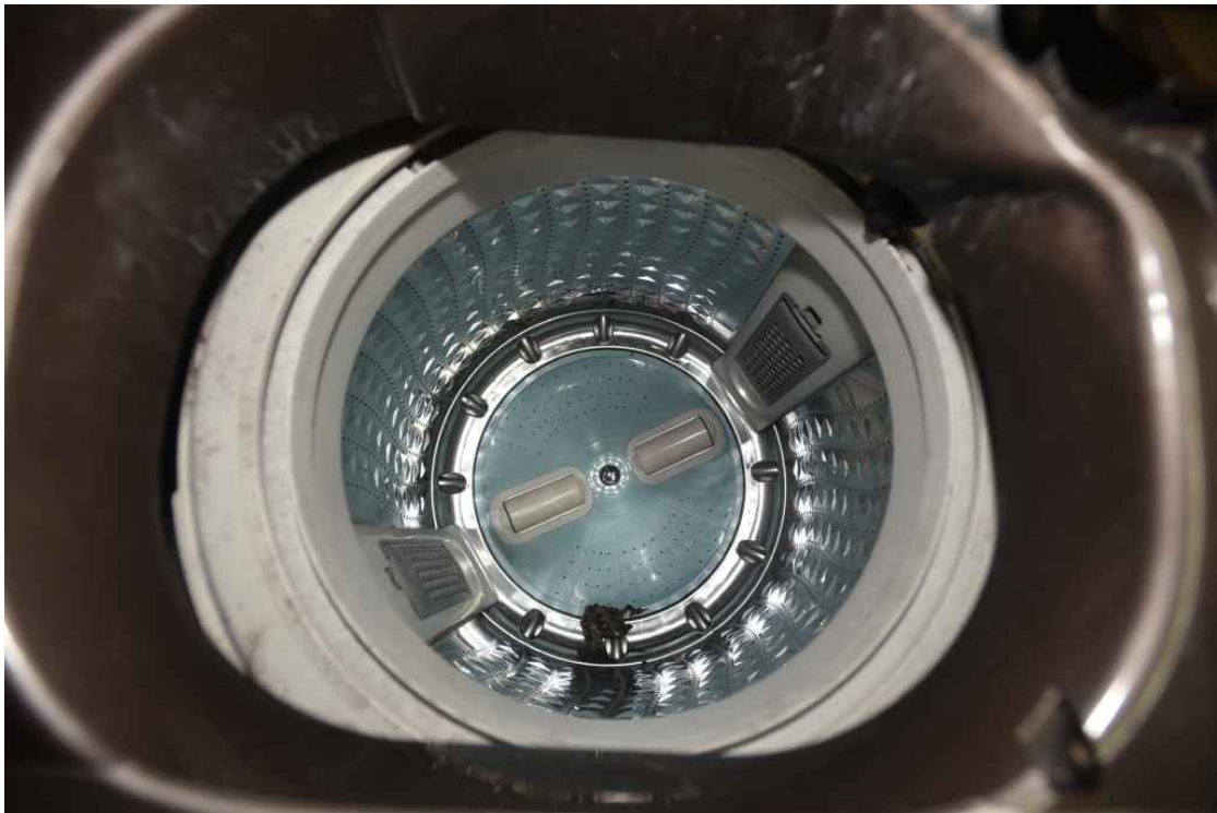
사진 8 세탁조 내부 상태 촬영날짜 ○ 화재당시 물이 차있던 상태로, 내부에 연소흔이 식별되지 않음 '17. 8. 25.
