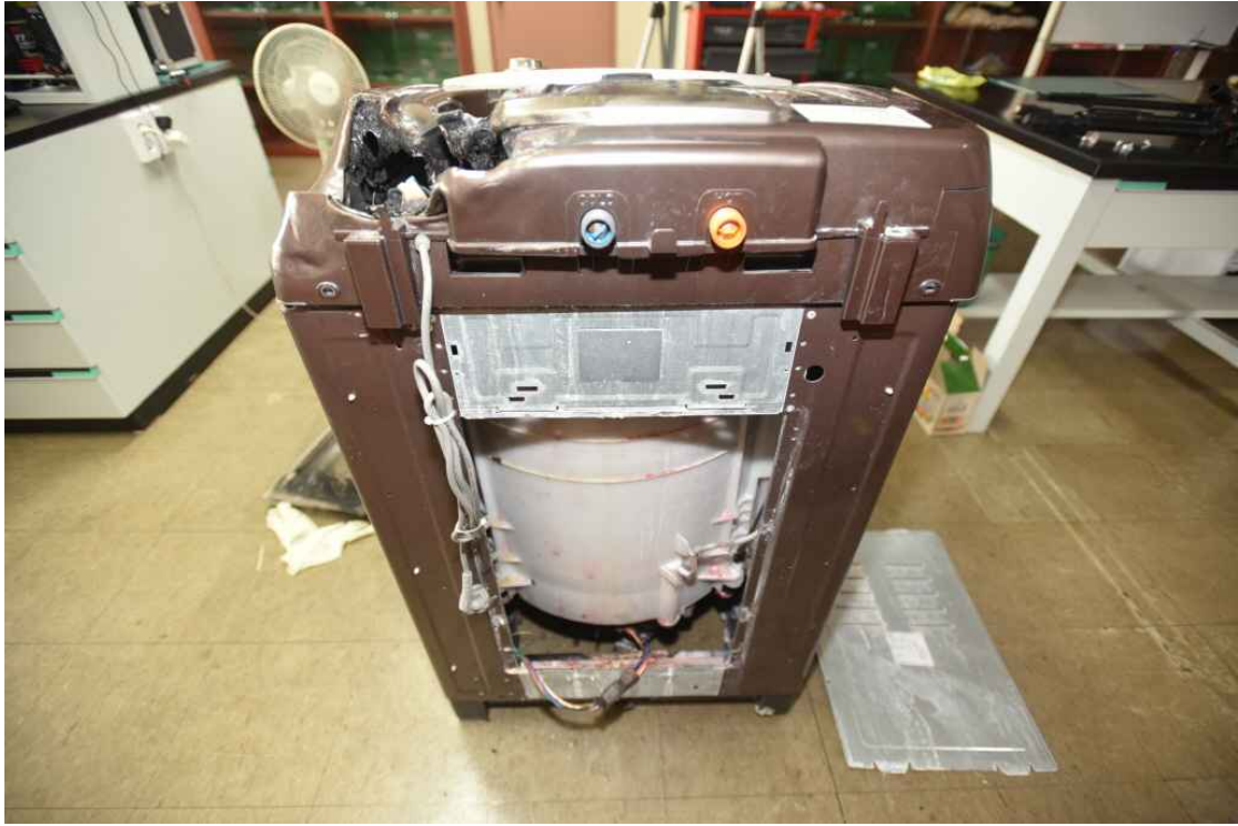
사진 9 세탁기 후면 철재 케이스 제거 후 상태 촬영날짜 ○ 세탁조 외부 및 하단에서의 소실흔이 식별되지 않음 '17. 8. 25.
