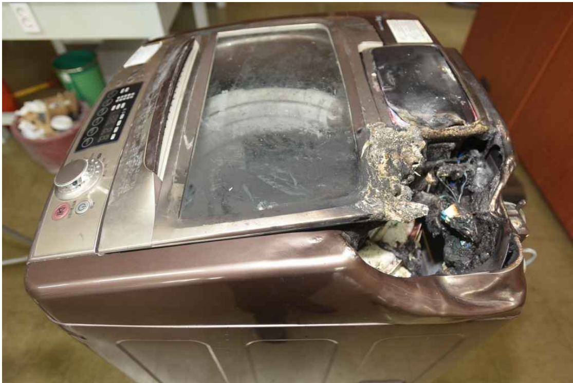
사진 14 우측 모서리 소실 상태 촬영날짜 ○ 플라스틱 케이스가 안쪽으로 휘어지며 녹아들어간 형상임 '17. 8. 25.
