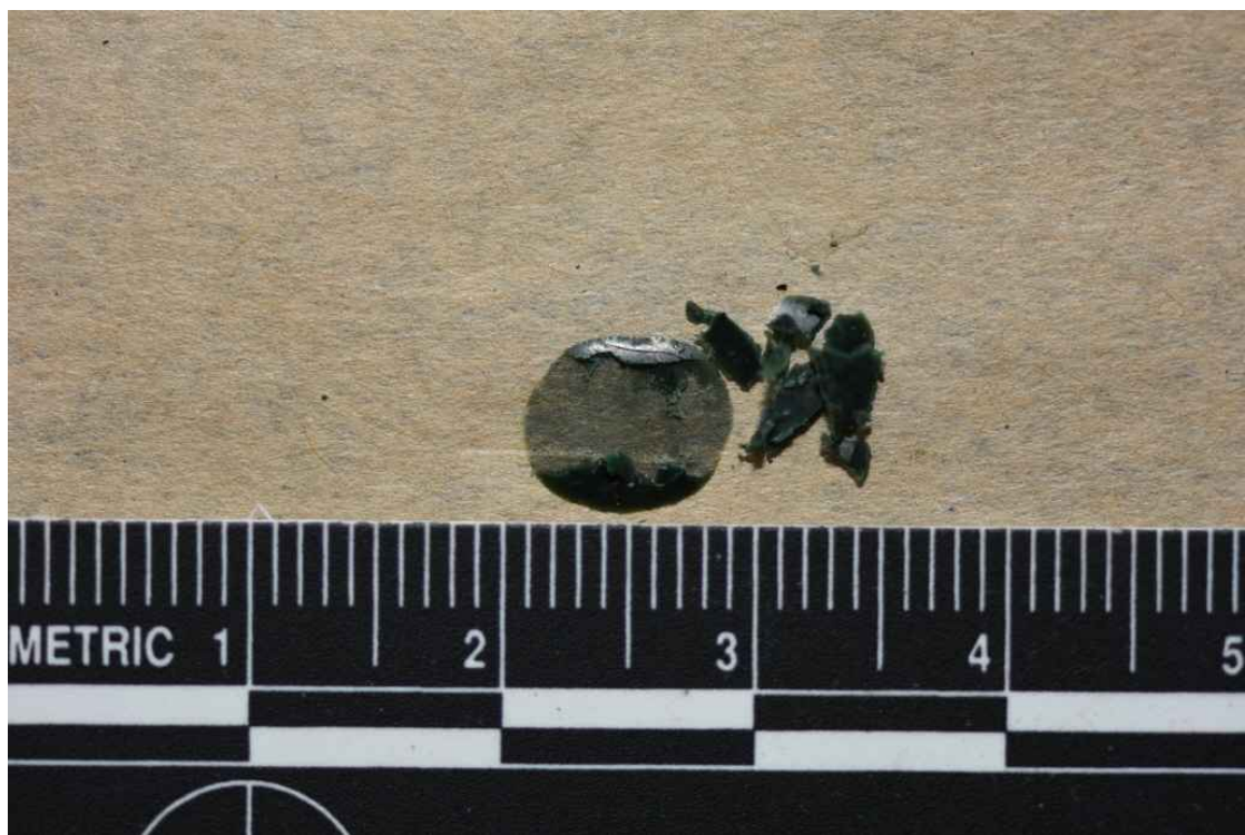
사진 40 녹아 굳은 고형체 상태 촬영날짜 ○ 찻농과 유사한 형태를 나타냄 '17. 8. 25.
