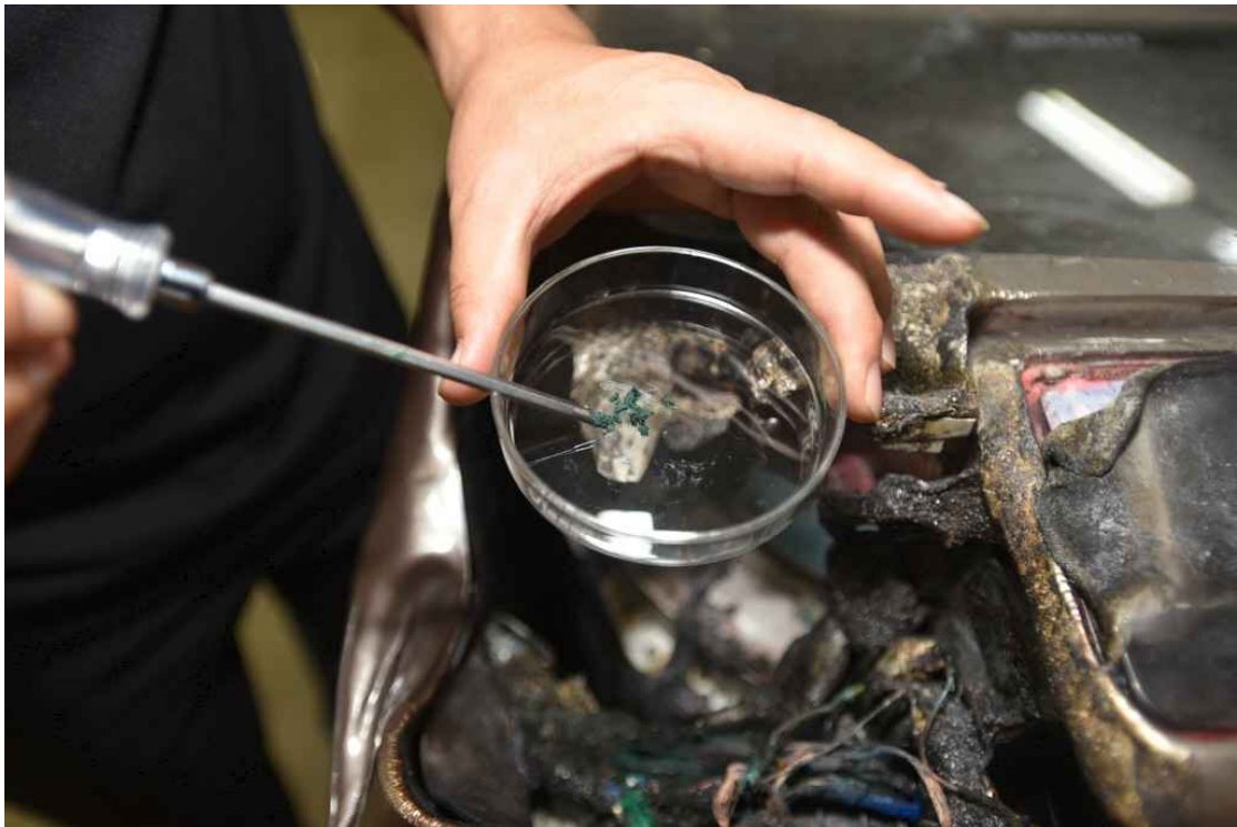
사진 42 감정의뢰 시료 2 채취 촬영날짜 ○ 경도가 무른 고형체를 채취 중인 시료 2 '17. 8. 25.
