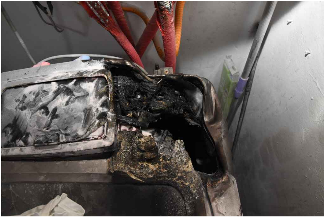
사진 3 화재현장 사진 촬영날짜 ○ 세탁기 우측 모서리를 중심으로 연소됨 '17. 8. 25.
