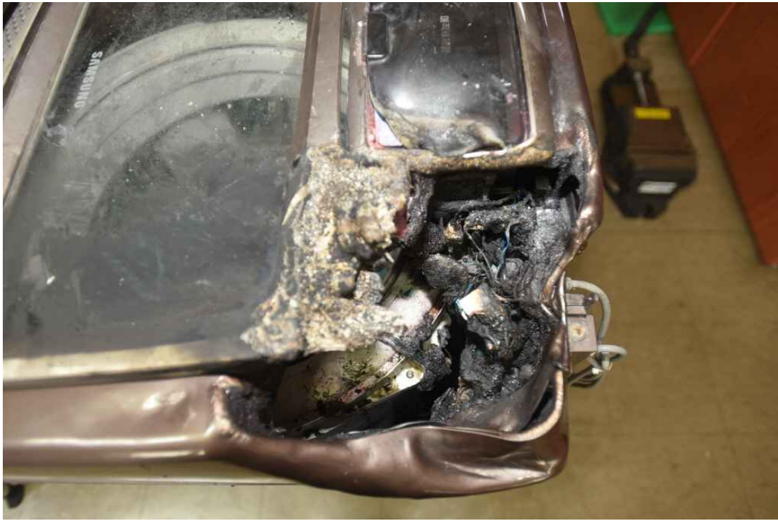
사진 15 우측 모서리 소실 상태 촬영날짜 '17. 8. 25.
