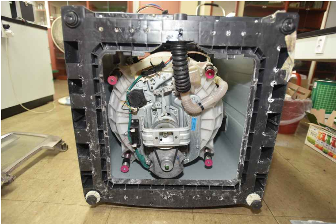
사진 10 세탁기 바닥 상태 촬영날짜 ○ 연소 특이점이 식별되지 않음 '17. 8. 25.
