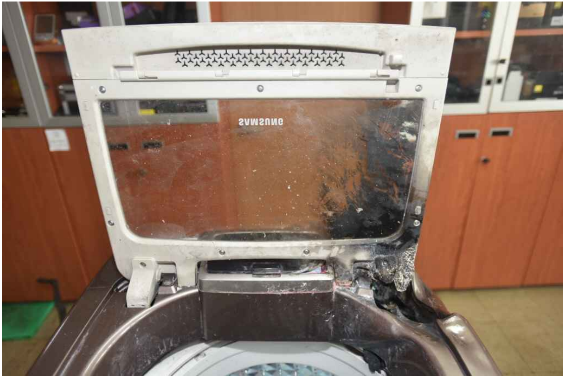
사진 17 세탁기 덮개 상태 촬영날짜 ○ 덮개 우측이 일부 소실되었으며, 덮개 상부에 그을음이 강하게 나타남 '17. 8. 25.
