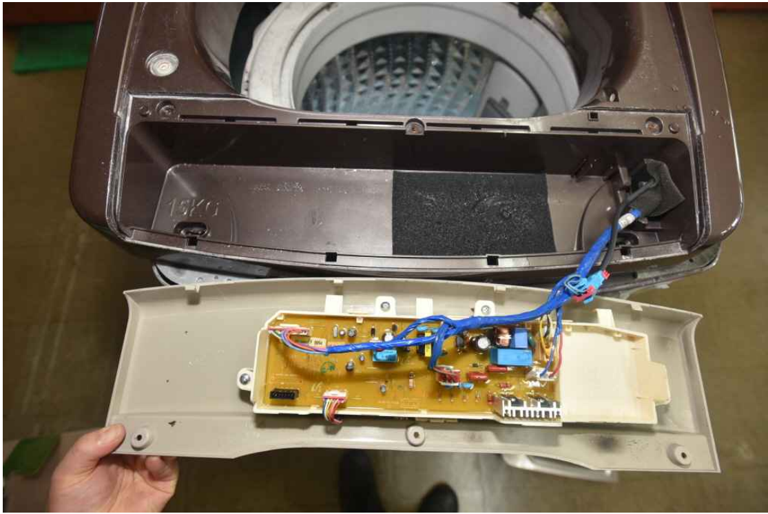
사진 43 컨트롤 스위치 및 기판 촬영날짜 '17. 8. 25.
