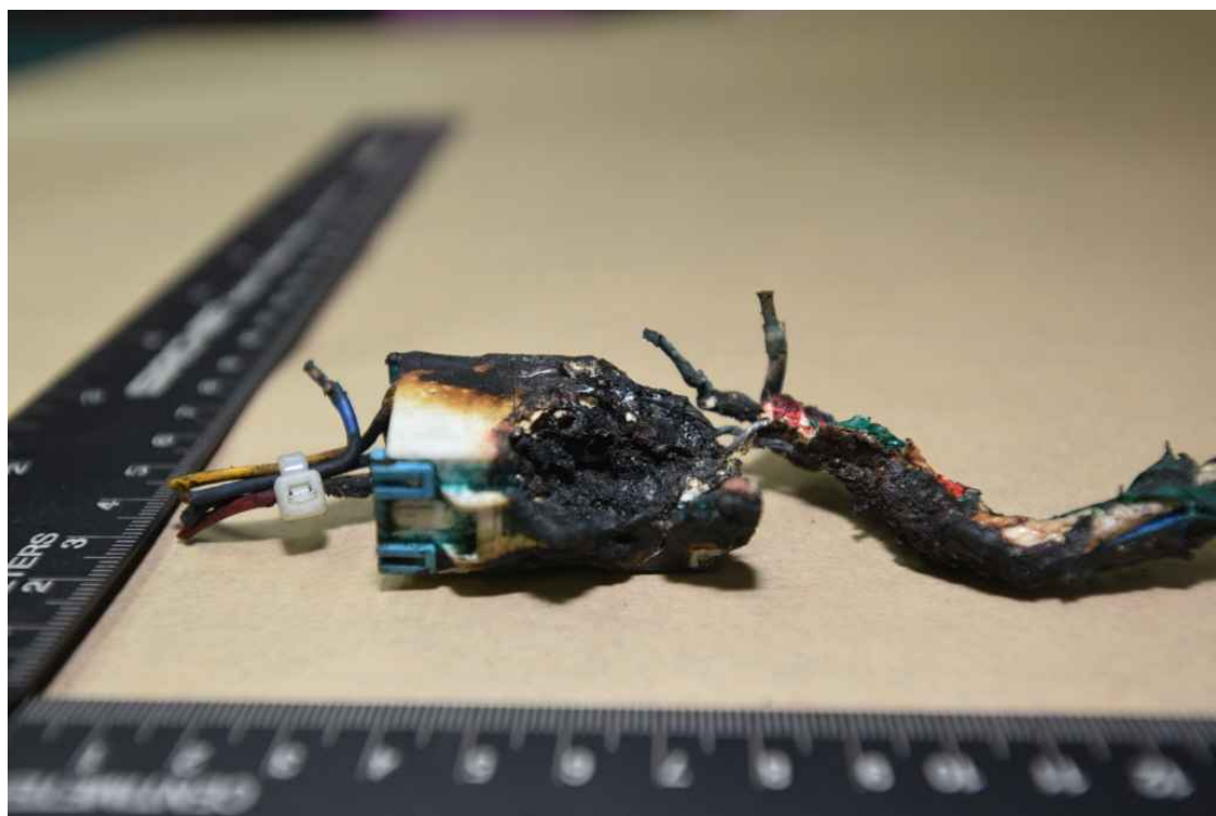
사진 22 커넥터 소실 상태 촬영날짜 ○ 우측 수단자 방향이 국부적으로 소실됨 '17. 8. 25.
