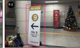
위치 이용자 동선 뒤쪽에 안내표지판이 부착됨. 주변 장식물이 가려 멀리서도 보이지 않음. 기둥구조물을 활용하지 않고 임시 안내표지판이 설치됨.
