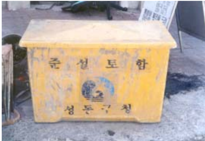
<사진 2.3> 준설량을 확인하기 위한 1㎥용량의 준설토함
