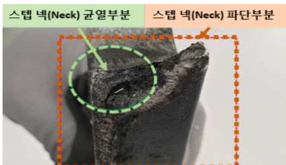
【스텝(Neck)부분 균열 및 파단부분】
