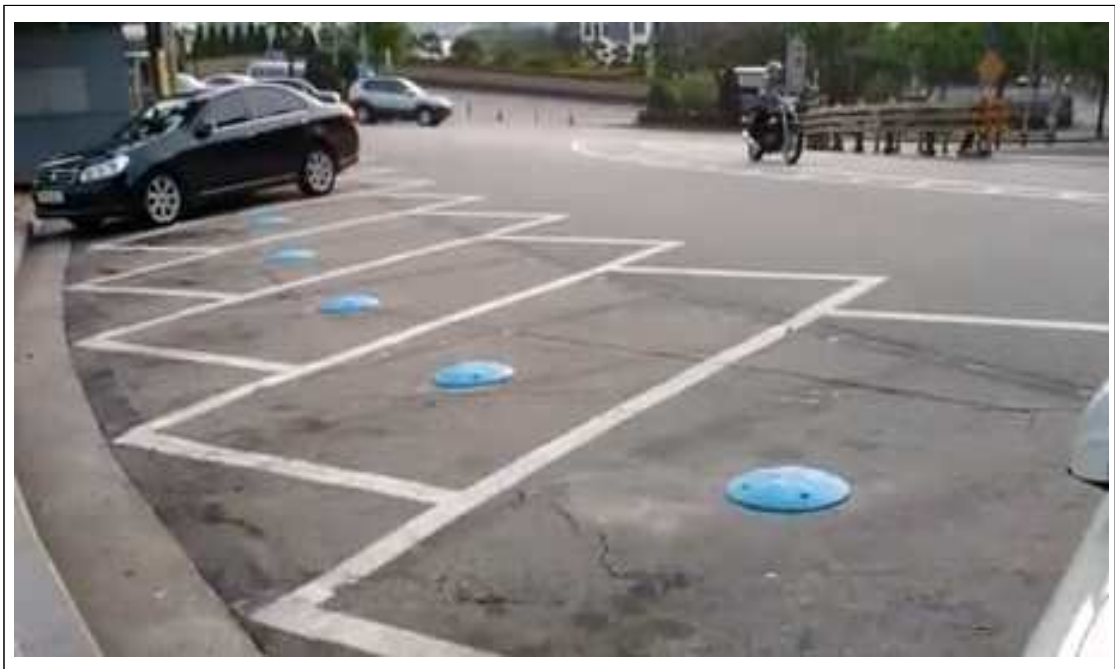
[그림 4-11] U-PiLOT(주차유도 시스템)에 설치된 Park Disk
