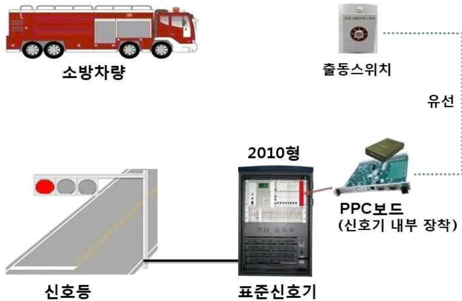
〈그림 II-11〉 소방관서 앞 소방출동 신호제어시스템 개념도
