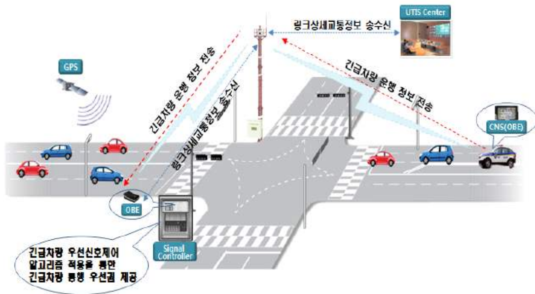
〈그림 II-7〉 UTIS 기반의 EVP 제어시스템 구성도 (홍경식 외, 2012)
