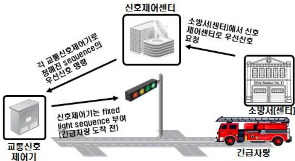
〈그림 II-3〉 중앙관제식(Route Preemption System) 개념도
