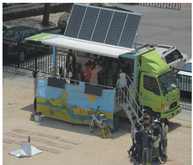
중형 '해요' (3.5톤 아-마יתי, 2007년식) 전기시설, 동력시설 및 태양광발전시설, 절수시설 등 설치·개조한 에너지체험교육 차량
