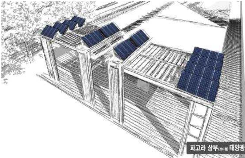
옥상녹화 조성시 도입하는 주요 시설물중 파고라를 활용한 태양광 발전설비 설치 유형
