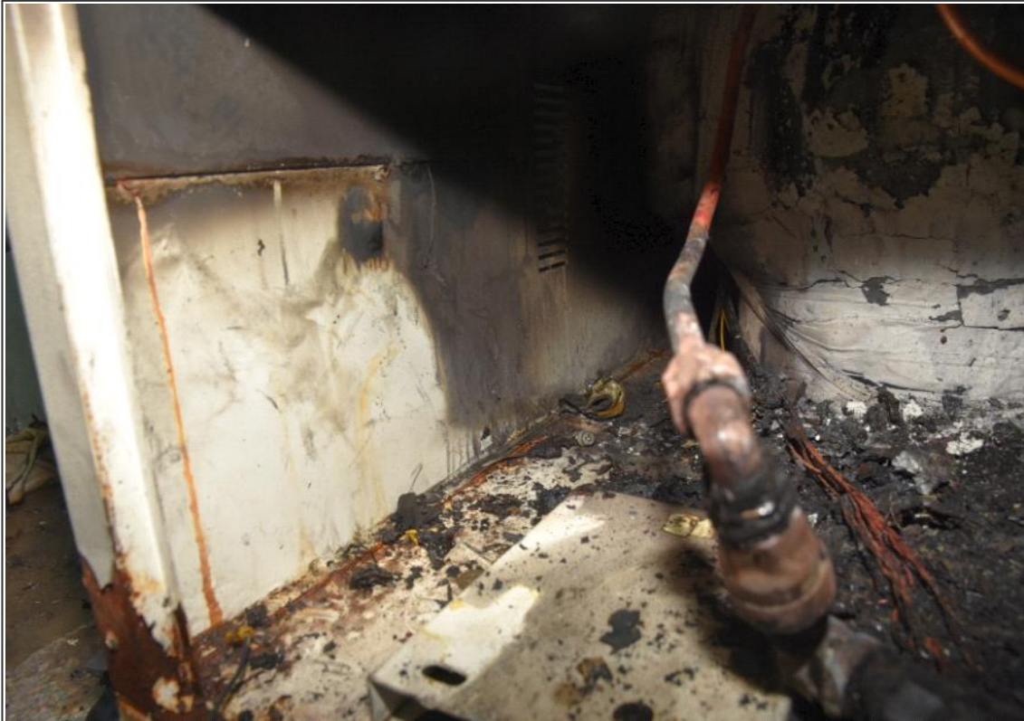
사진 19 보일러 내부 좌측 연소상황 촬영날짜 ○ 전면은 특이점이 없고 후면쪽이 검게 탄화된 모습 2019.05.07.
