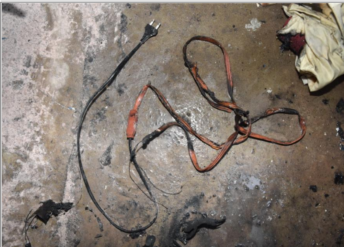
사진 22 보일러 내부 전기열선 촬영날짜 ○ 외부 화염에 의해 연소된 모습으로 발화 특이점 없음 2019.05.07.
