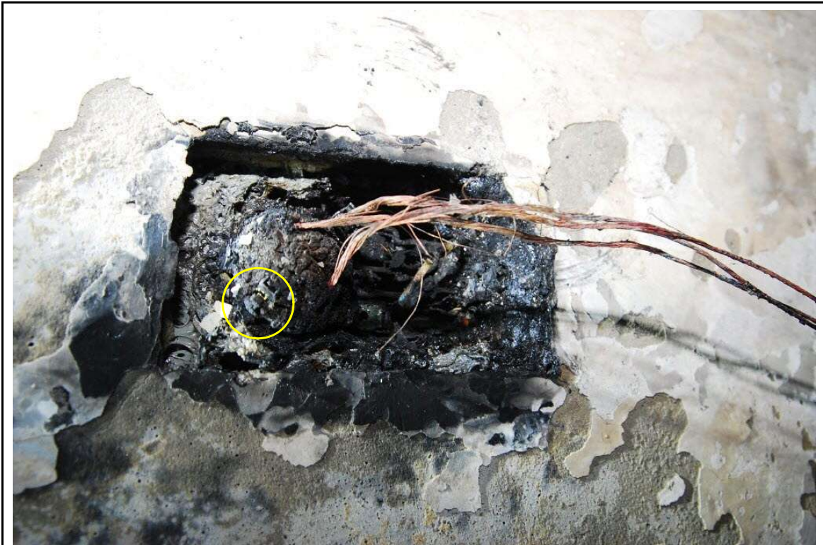
사진 5 벽면 콘센트에 연결된 청소기 코드선 (좌측 90도 회전) 촬영날짜 ○ 사진에 표시한 ○ 부분에서 전기적 용융흔이 발견됨 '11. 10. 26.
