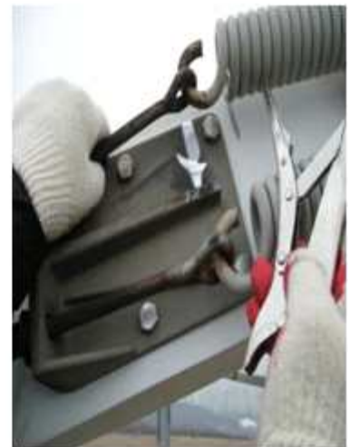
Blade Springs 고정틀 마모 상태
