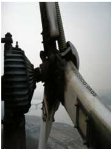
기어유 유출로 인한 오일 오염 상태
