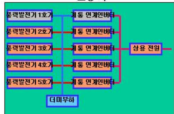
1호기 풍력발전기 및 계통연계인버터 고장 시
