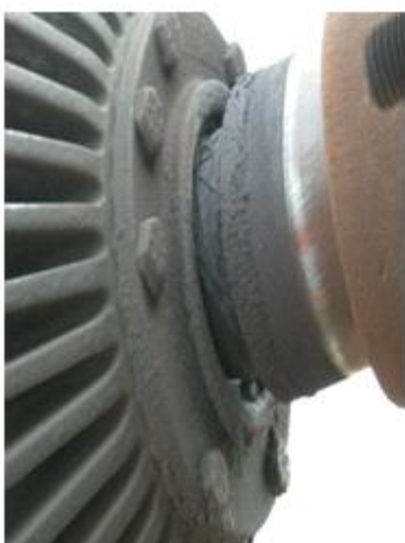
기어유 유출로 인한 오일 오염 상태
