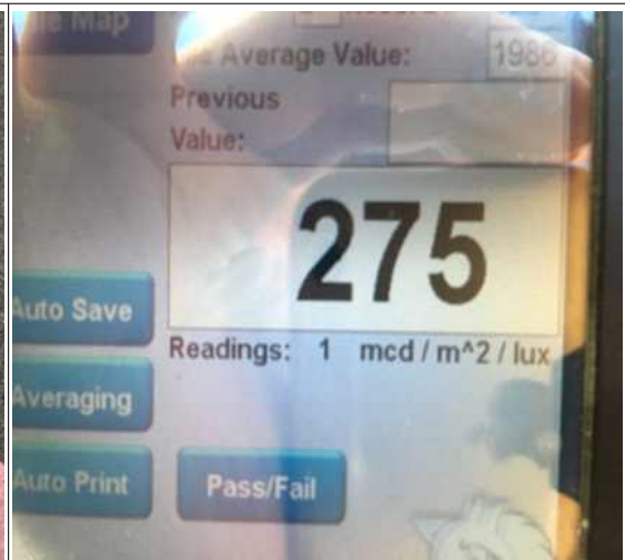
분홍색 휘도결과 275mcd/m 2 ·Lux
