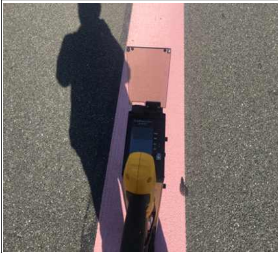
분홍색 휘도결과 289mcd/m 2 ·Lux
