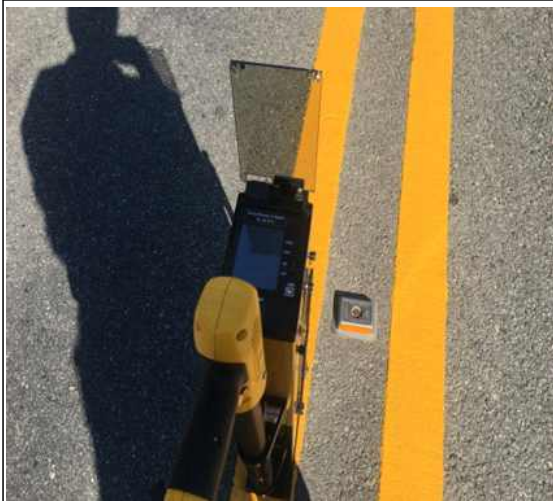
황색 휘도결과 214mcd/m 2 ·Lux
