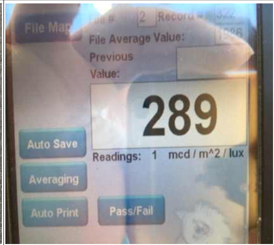
분홍색 휘도결과 289mcd/m 2 ·Lux
