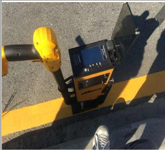
황색 휘도결과 185mcd/m 2 ·Lux
