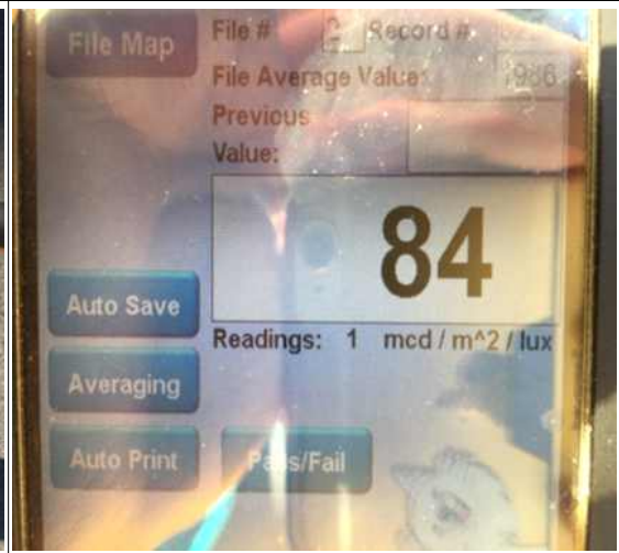
청색 휘도결과 84mcd/m 2 ·Lux
