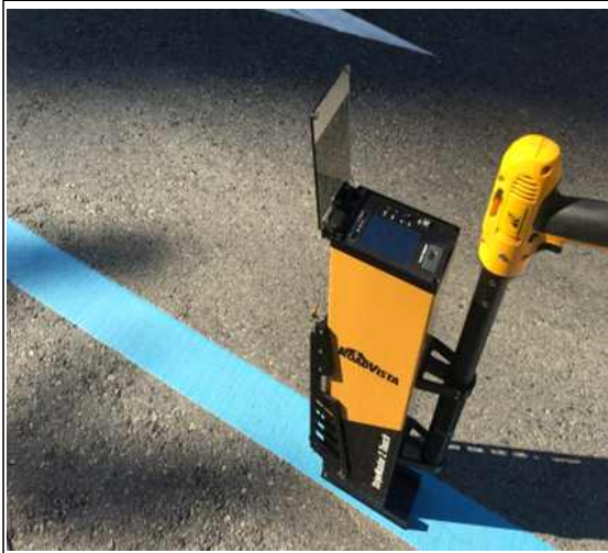
청색 휘도결과 84mcd/m 2 ·Lux
