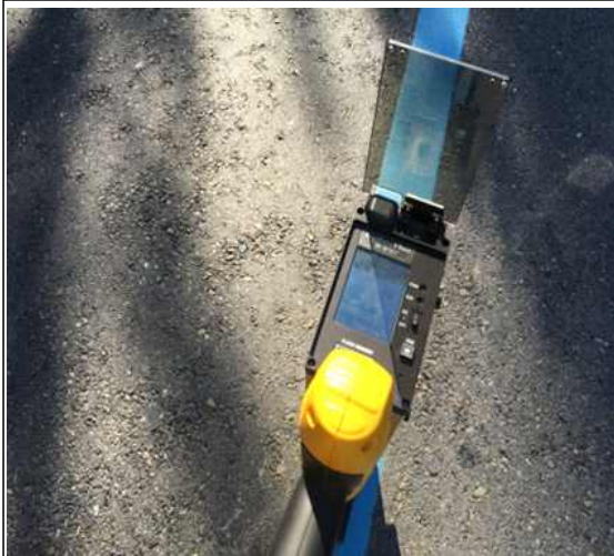
청색 휘도결과 98mcd/m 2 ·Lux
