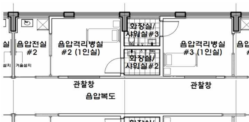
그림 23 음압복도와 음압격리병실사이 벽에 관찰창을 설치한 사례
