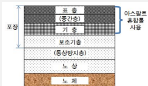
< 아스팔트 콘크리트 포장 단면 구성 >
