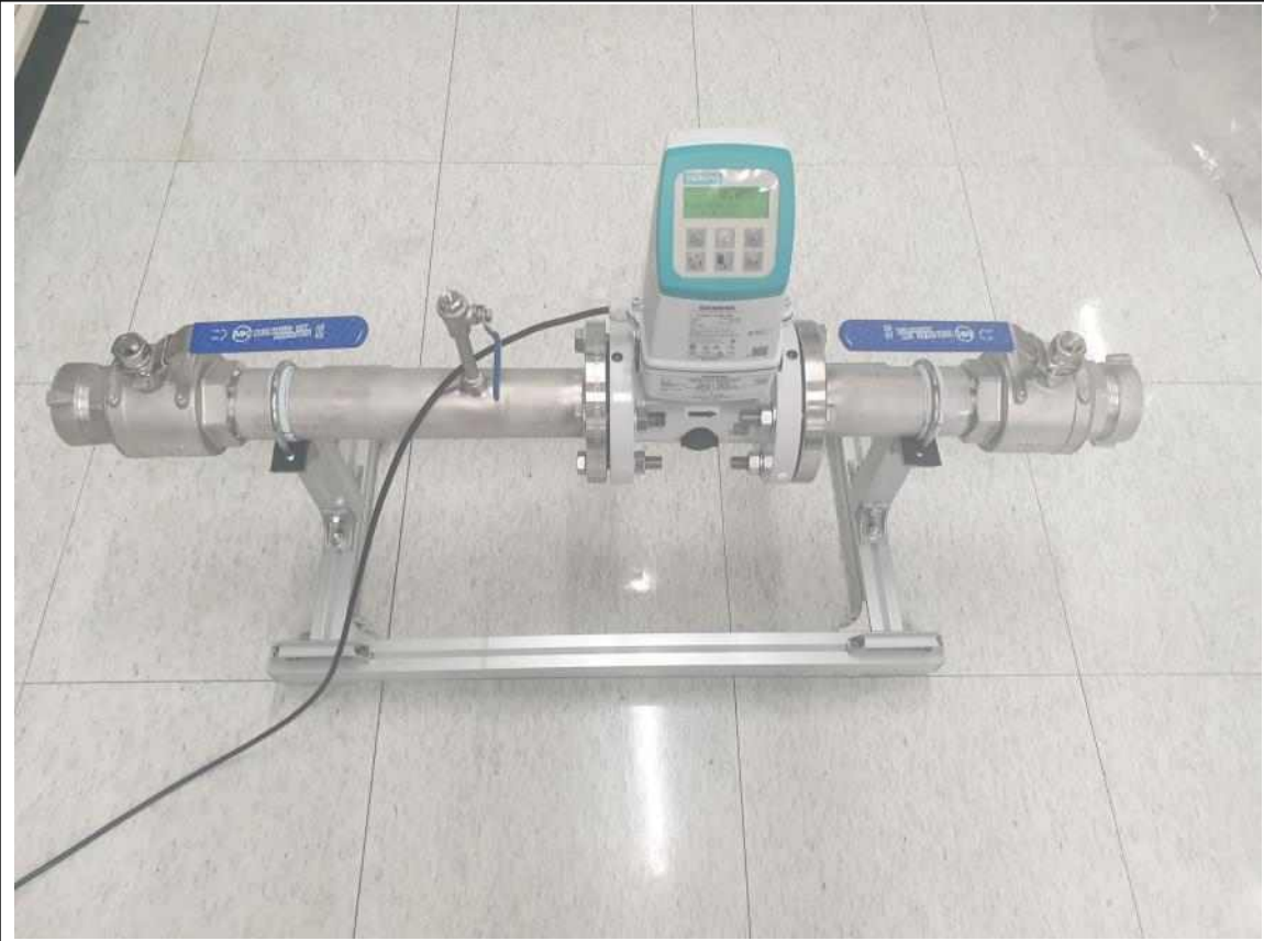
▲ 물 세척 시 상수도관 유속, 유량 측정 장치
