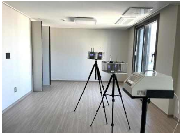
신축 공동주택 실내공기질 측정 현장
