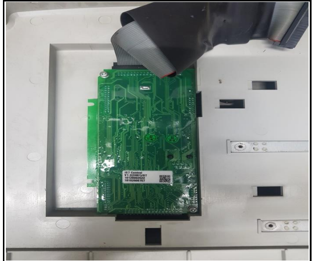
내용 C-PCB 교체 후
