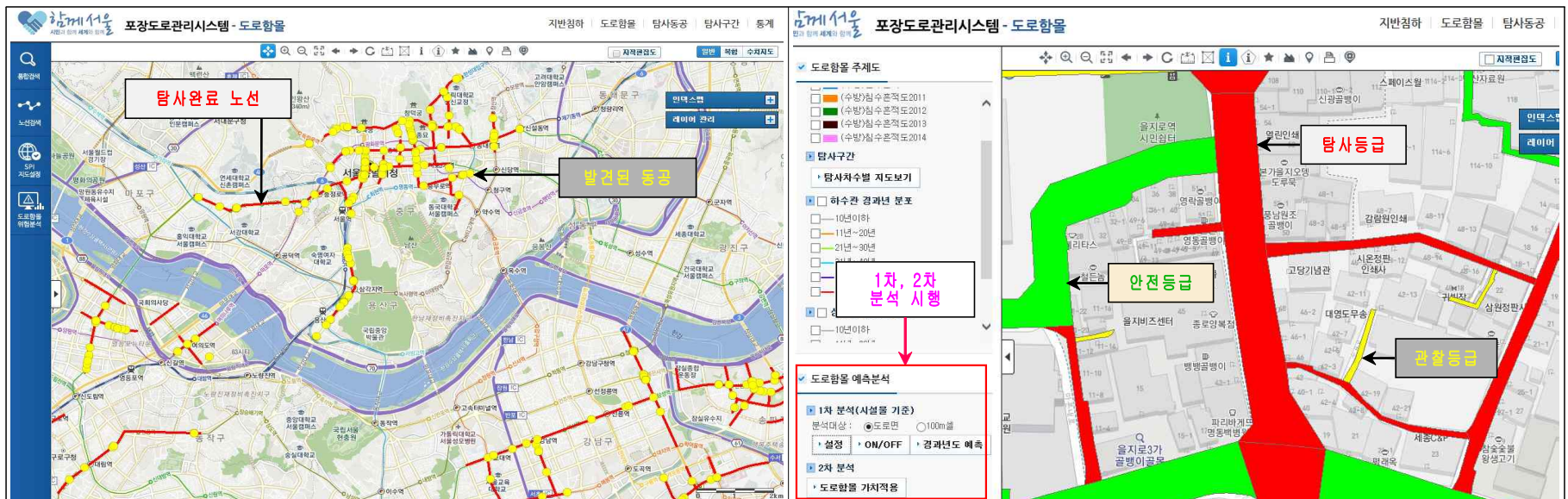
도로함몰 관리시스템의 예측분석 기능 (생활도로, 지선도로의 탐사등급(■)은 상대적으로 붕괴우려가 낮은 소규모이고 순찰, 신고시스템 등으로 발생후 신속발견 조치)
