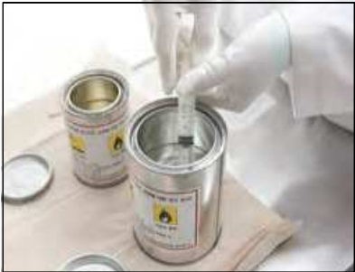
주사기를 이용한 접착제 혼합
