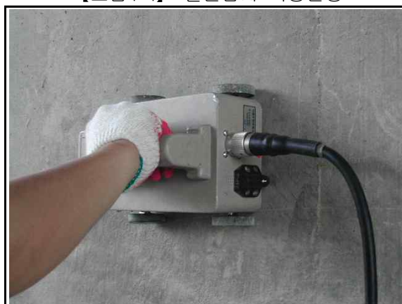
【그림4-4】 철근탐사 측정전경
