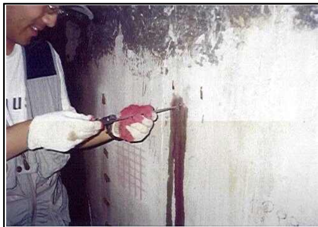
【그림4-7】 중성화시험 측정전경
