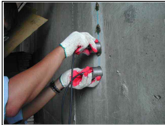
【그림4-3】 초음파탐사 측정전경
