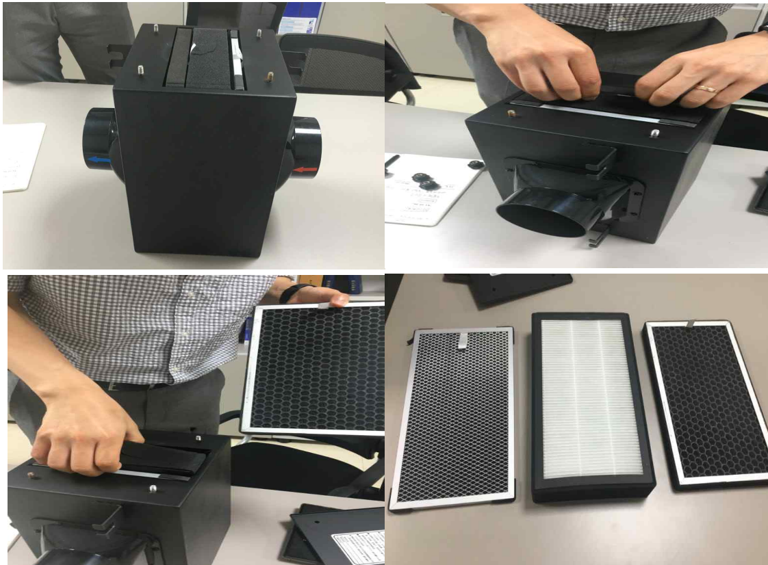
Figure 23. 3중 필터 방식의 유해물질 제거 시스템
