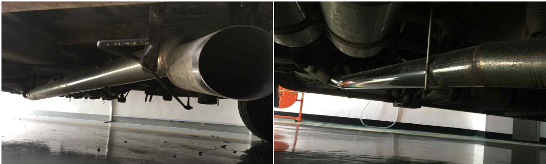
Figure 9. 강원도 소방본부에서 구조 변경하여 사용 중인 배기관 모습
