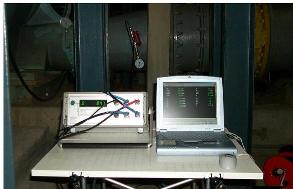
그림 8. 펌프 성능 측정 장치
