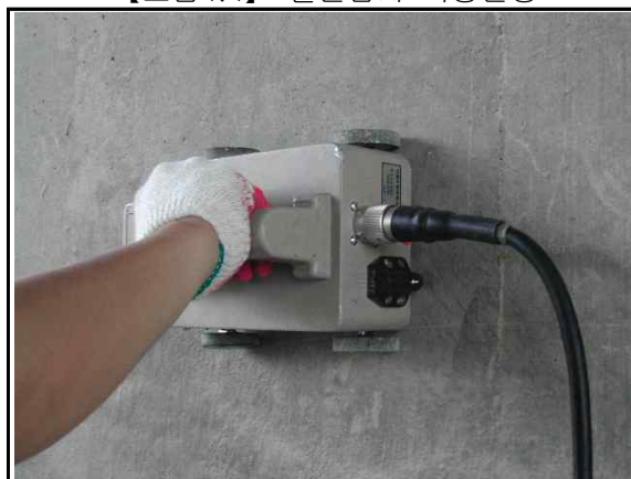
【그림4.4】 철근탐사 측정전경
