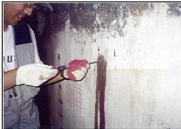
【그림4-7】 중성화시험 측정전경
