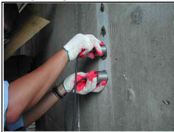
【그림4.3】 초음파탐사 측정전경
