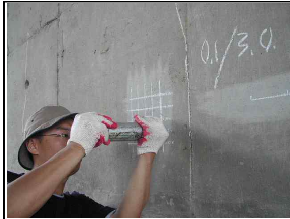
【그림4.2】 슈미트 햄머 측정전경
