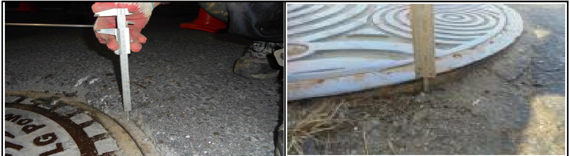
[그림3.1] 뚜껑면과 포장면의 단차조사 예시
