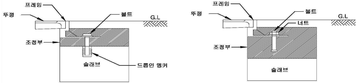
[그림5.1] 철개고정장치 설치 예시
