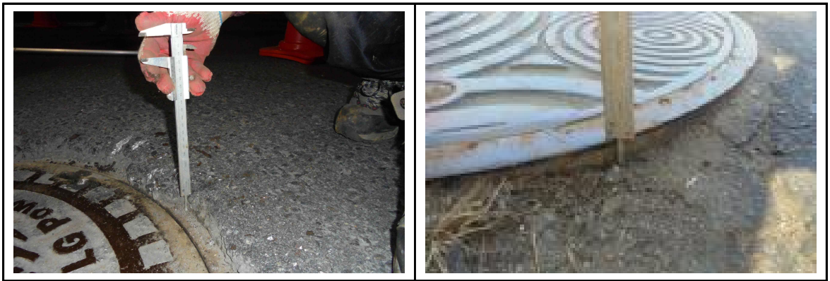
[그림3.1] 뚜껑면과 포장면의 단차조사 예시
