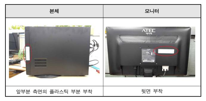
※ 본체 : 전자태그를 금속에 부착하면 리더기가 전자태그코드를 인식 못하므로 **반드시** 플라스틱에 부착 ※ 모니터 : 뒷면 및 받침대가 플라스틱이므로 부착 부분의 제한은 없으나 위 사진부분을 권장함
