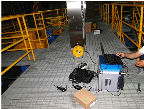
[사진3] 열역학적측정계기 설치
