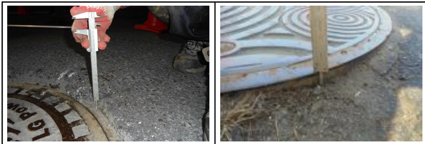
[그림 3.1] 뚜껑면과 포장면의 단차조사 예시
