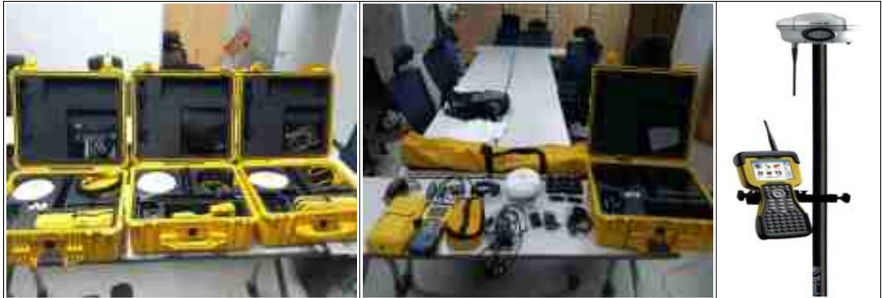
[그림 28] GNSS 정지측량 관측 장비
