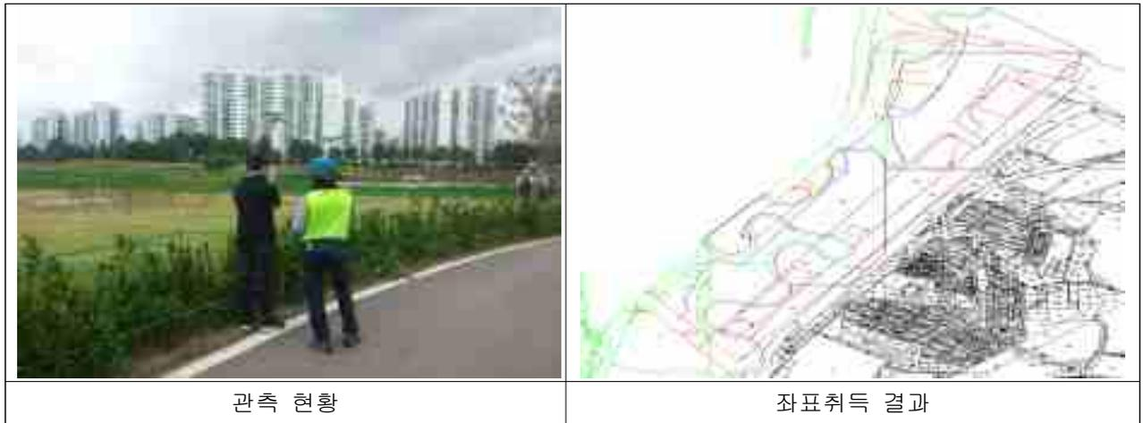
[그림 39] 네트워크 RTK 방법에 의한 좌표 취득 결과
