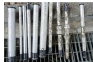
〈 강서한강공원 〉 고농도 염소이온에 의한 스테인리스강의 부식
