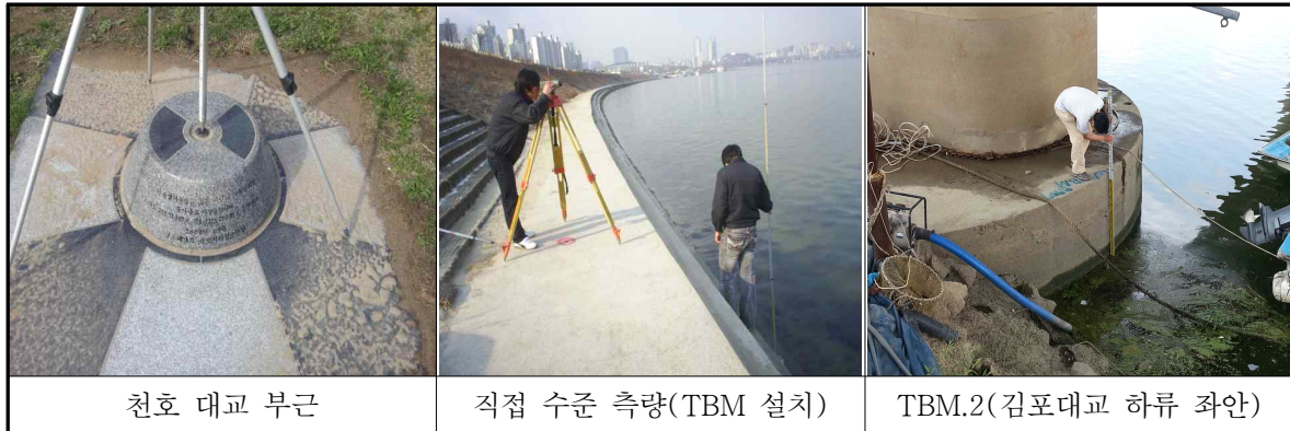
<그림 4.3-2> 통합 기준점 및 TBM 설치
