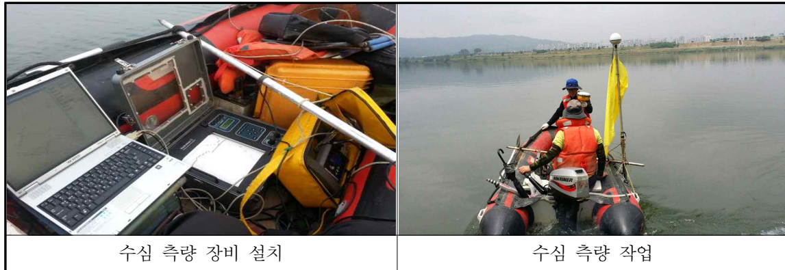
<그림 4.2-2> 수심 측량 장비 설치 전경 및 작업
