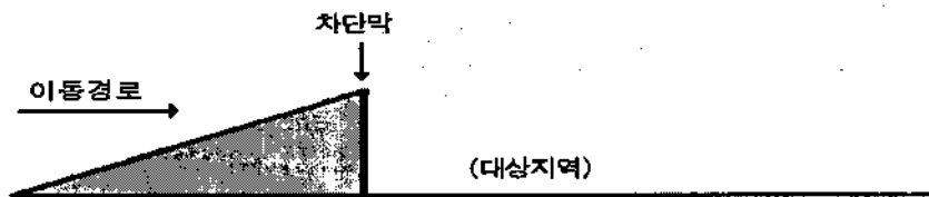
〈그림 B〉 상승기류를 고려한 차단막 설치
