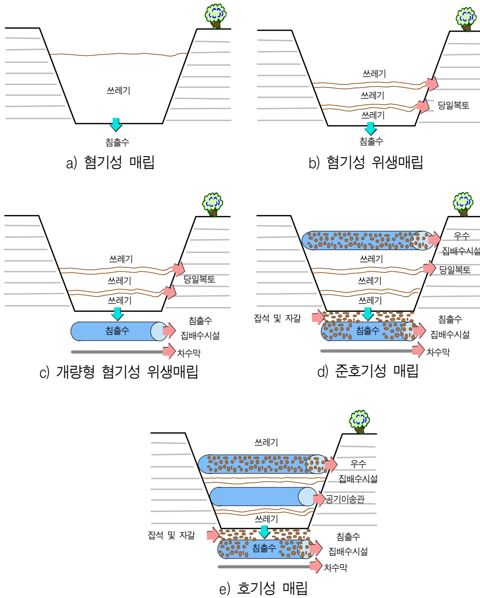
<그림 2-6> 생물학적 분해조건에 따른 매립지의 구조
