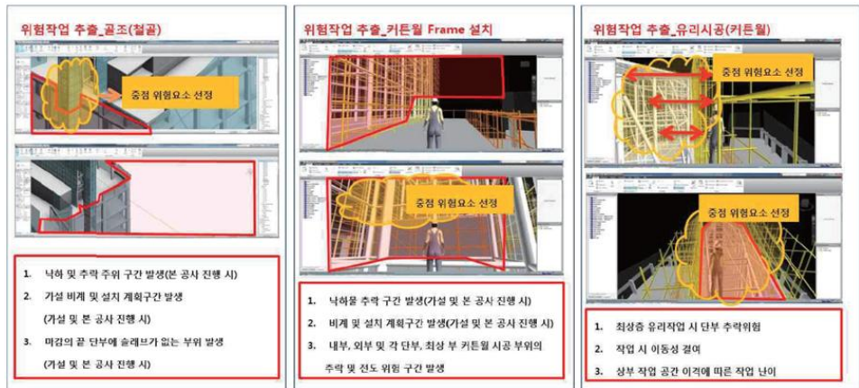
[그림 3-7] 공동주택 BIM 모델링을 통한 안전관리
