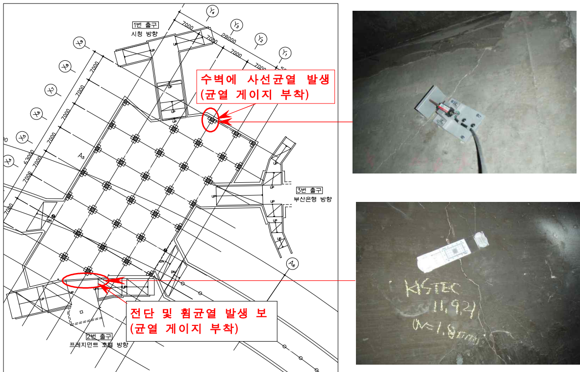
<그림 2.2-4> 보의 균열위치 및 발생 형태
