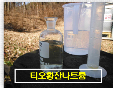
<사진 2.3.2> 위클러-아지드화나트륨 변법에 의한 용존산소 측정
