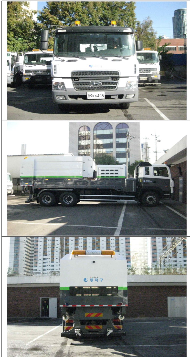
살수차량(89마6405) 개조하여 도로분진청소장비 설치
