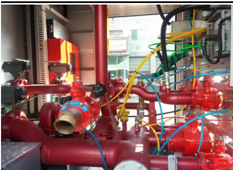
펌프 시스템(물탱크 1500 ℓ)
