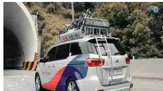
〈터널 스캐닝 점검〉
