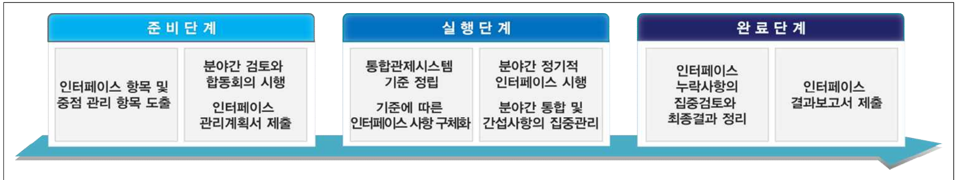
[그림-2] 1~9호선 지능형 SMART 통합관제 시스템 구축 관련 분야간 인터페이스 관리절차
