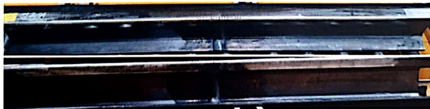
< 60 kg 경두레일 테르밋트용접 No.2 굴곡시험 후 >
