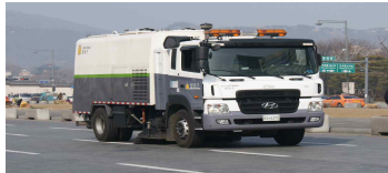
〈 도로 중앙측 분진흡입작업 〉
